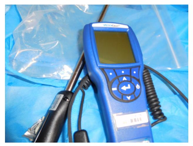
Figure 9. TSI<sup>®</sup> VelociCalc<sup>™</sup> Plus Model 9555-P thermal anemometer (Photo Credit: NIOSH)
