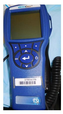
Figure 4. TSI<sup>®</sup> VelociCalc<sup>™</sup> Plus Model 9565-P thermal anemometer (Photo Credit: NIOSH)
