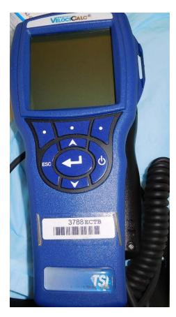
Figure 7. TSI<sup>®</sup> VelociCalc<sup>™</sup> Plus Model 9565-P thermal anemometer (Photo Credit: NIOSH)
