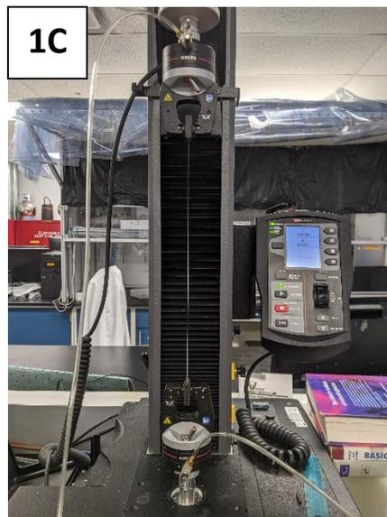
**Fig. 1C. Instron 5934 Tensile Tester**
