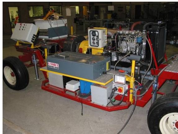
**Figure 3. Dynamometer/Isuzu C240 system**
