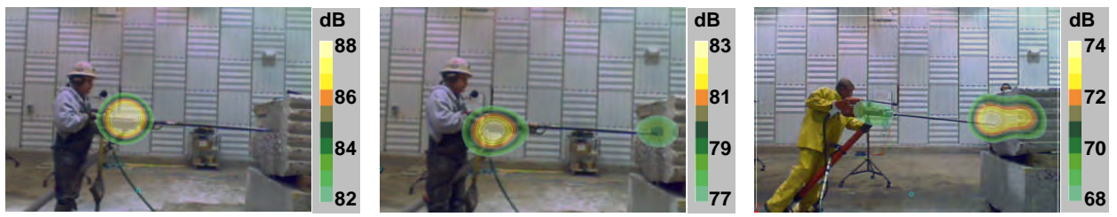
(d) S83 at 2000 Hz. (e) S83 w/muffler at 2000 Hz. (f) TE MD20 at 2000 Hz.
