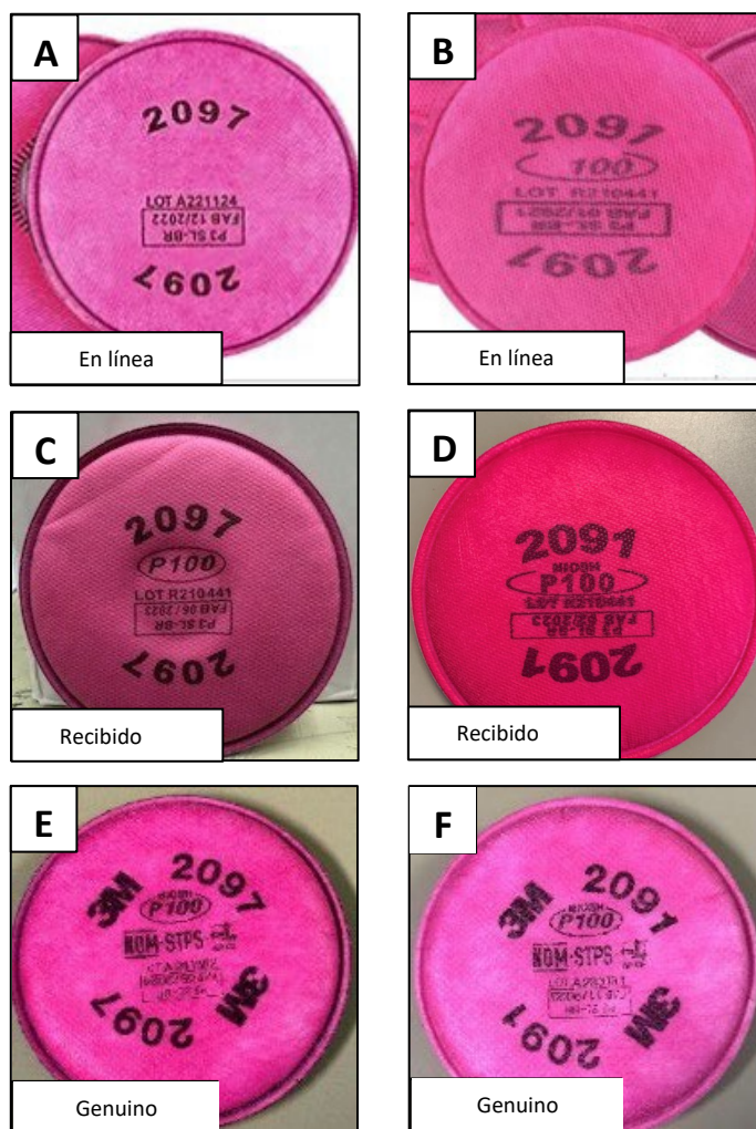
Figura 2: Ejemplo de la apariencia de los filtros fraudulentos en el mercado en línea (A y B), la apariencia de estos filtros fraudulentos cuando NIOSH los recibió (C y D) y la apariencia de filtros P100 2097 y 2091 genuinos de 3M (E y F).
