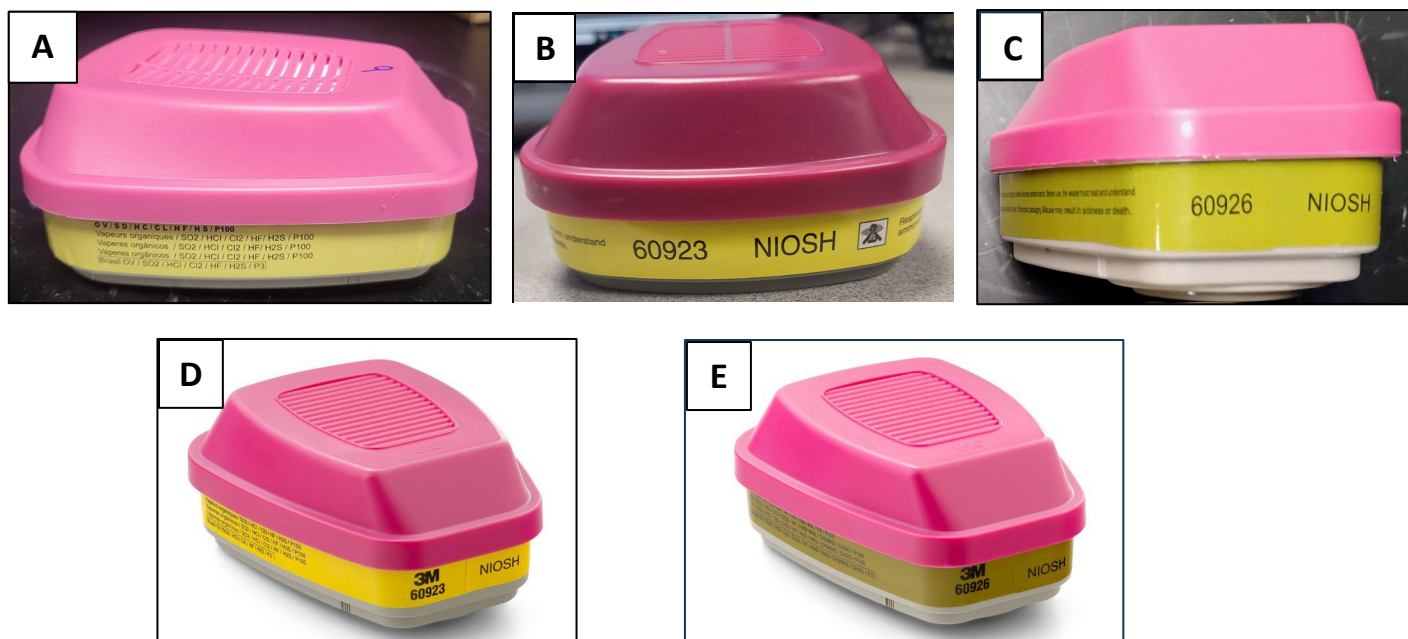
Figura 3: Ejemplos de cartuchos fraudulentos que representan engañosamente los cartuchos combinados genuinos 3M 60923 y 3M 60926. La imagen A muestra un cartucho 60923 fraudulento con la marca de certificación P100. Las imágenes B y C muestran cartuchos fraudulentos con la palabra “NIOSH”. Las imágenes D y E muestran cartuchos 60923 y 60926 genuinos.
