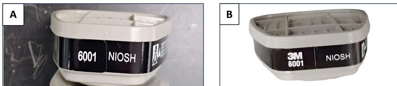
Figura 4: Ejemplos de un cartucho químico 6001 fraudulento (A) con etiqueta similar a la de la pieza genuina 3M 6001 (B), con excepción de la ausencia de “3M” en los cartuchos químicos fraudulentos.
