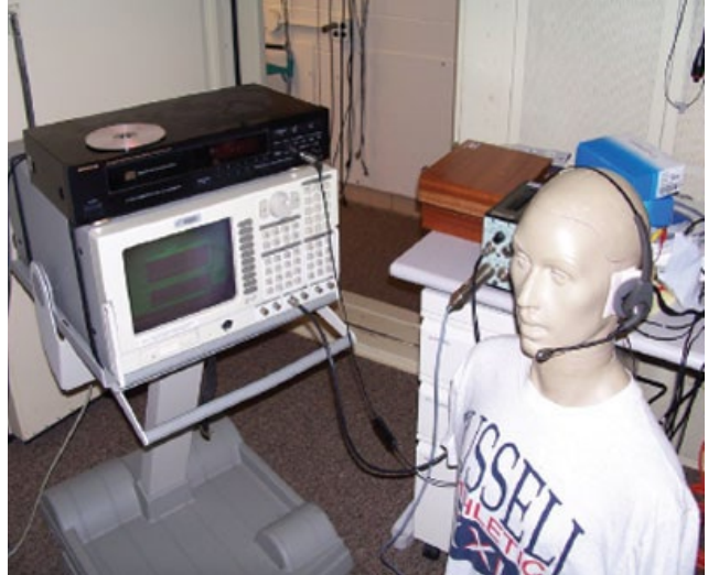
Figura 2. Realización de pruebas de laboratorio mediante un modelo de cabeza artificial acústica KEMAR.
