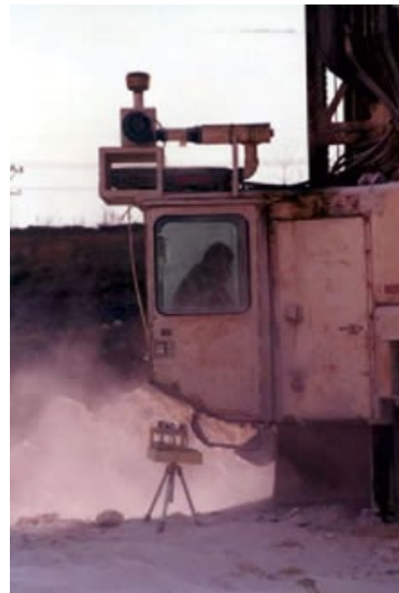
Figura 1. Los sistemas de filtración y presurización de la cabina evitan que el polvo penetre en las cabinas.
