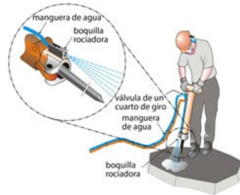
Figura 2 Diagrama del dispositivo de control por rociado de agua utilizado en el estudio de NIOSH.
