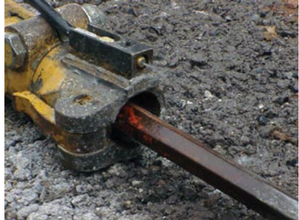
Figura 1 Accesorio rociador de agua; manera de conectar la boquilla a la herramienta.
