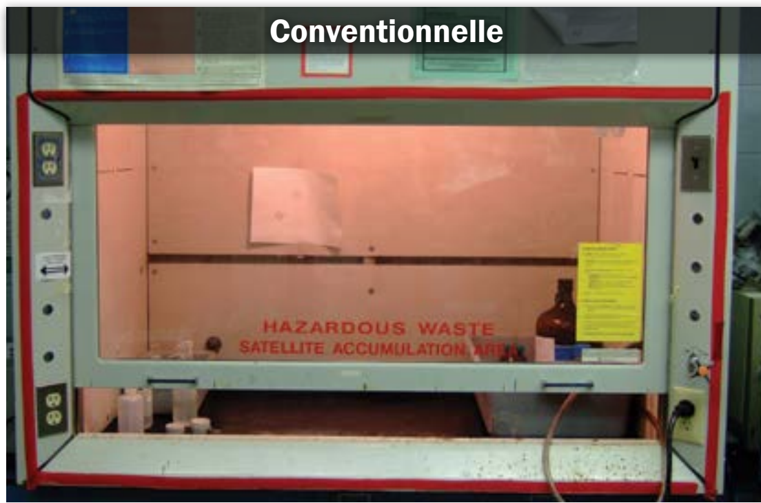
Figure 10. Hotte de laboratoire de chimie conventionnelle (à flux constant).
