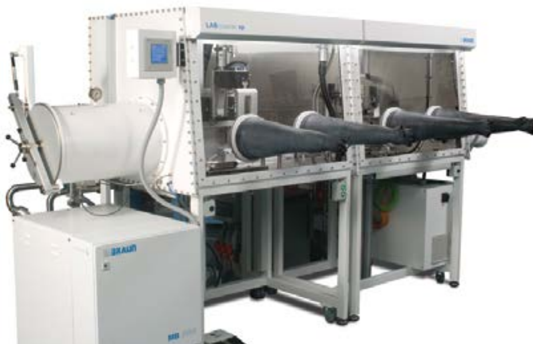
Figure 13. Boîte à gants (représentée ici sous une pression positive pour une utilisation avec des atmosphères inertes, plutôt que pour le confinement renforcé de particules et de gaz) (utilisé avec l'autorisation de MBRAUN).
