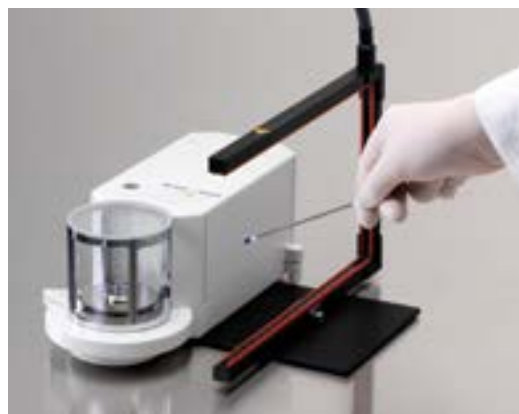
Figure 17. Exemple d'un appareil antistatique en U utilisé avec une microbalance (photo reproduite avec l'autorisation de METTLER TOLEDO).
