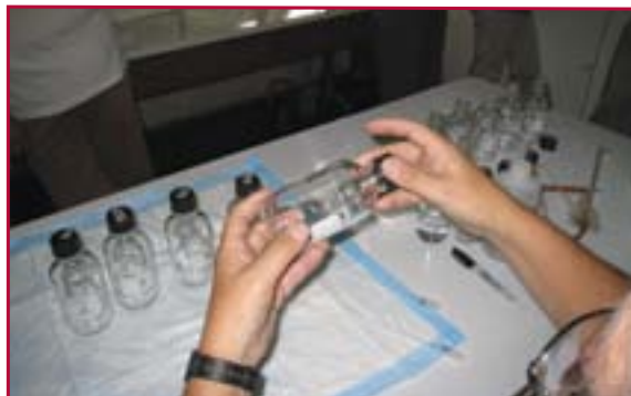
Figura 5: Revestimento das laterais do frasco.
