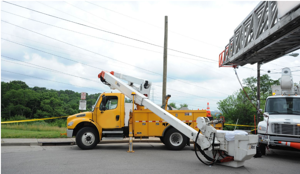
Foto 1. Camión grúa con elevador de pluma articulada Freightliner M2. Cortesía de la ciudad
