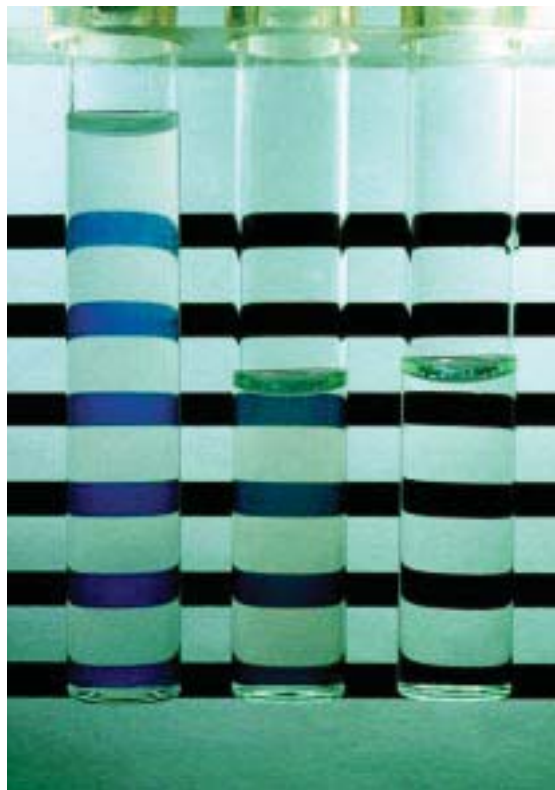
Figure 9-3. Comparaison de McFarland 0,5 avec la suspension de l'inoculum. De gauche à droite, les tubes sont le standard McFarland 0,5, E. Coli ATCC 25922 ajusté à la turbidité McFarland 0,5 et la solution saline non inoculée.
