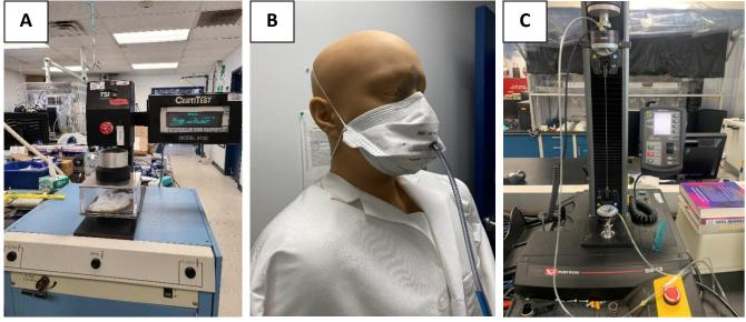
Fig. 2A. TSI 8130 Filter Tester
