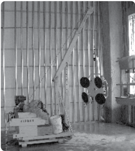
Un elevador motorizado con mecanismo al vacío evita levantar objetos manualmente
