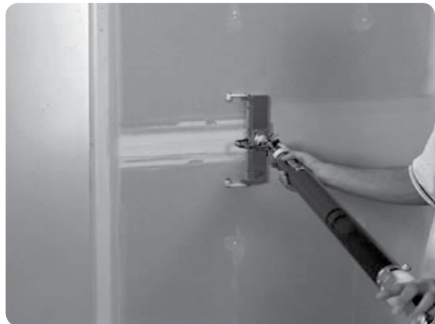
Solución: Sistema de acabado neumático
